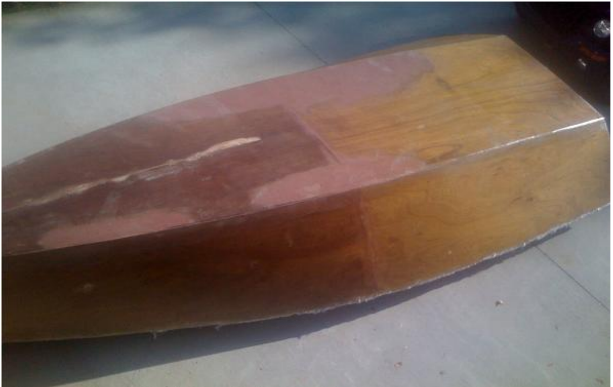
Корпус 36 вверх килем, остекленный и обтекаемый.
