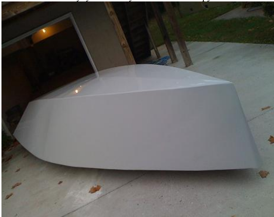
Законченный корпус, готовый к перевороту и отделке палубы.
