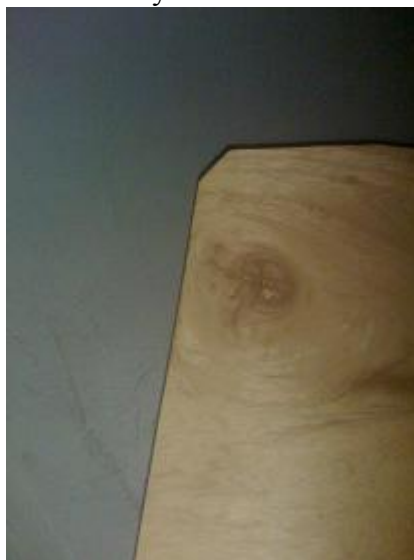
Показан нижний угол, подрезанный для присоединения к скуле
