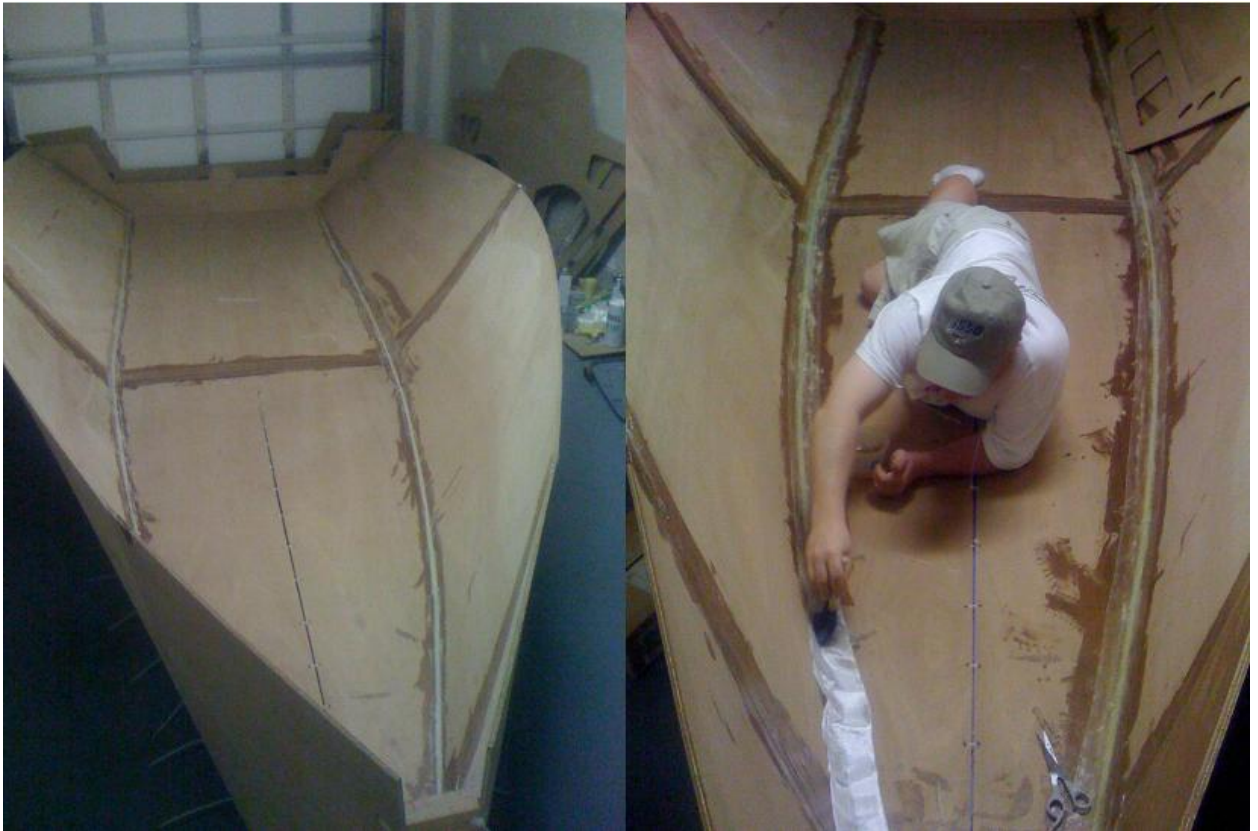
Замазка слева и заклейка швов справа.
