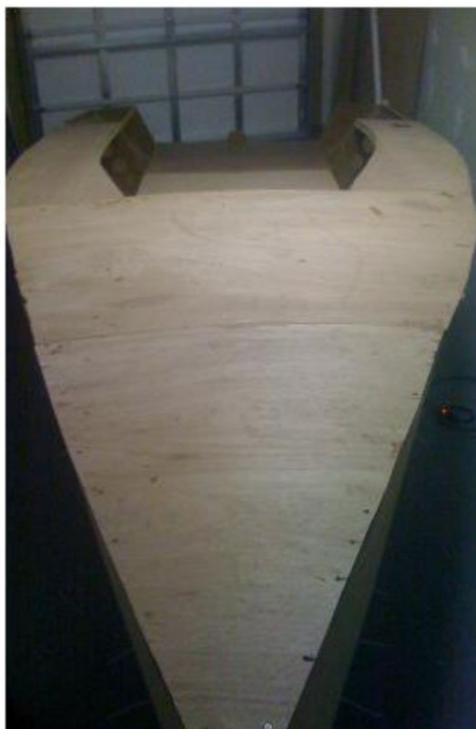
Палуба помещена на место, углы выпилены немного большего размера для точной подгонки
