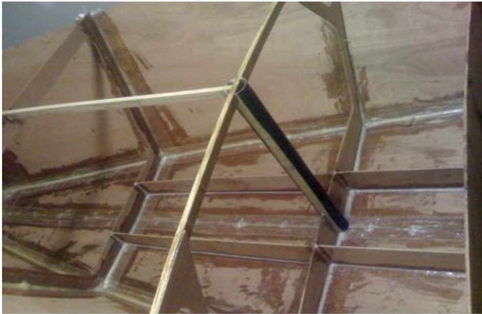
Показана установленная поддержка койки с пиллерсом на шпангоуте 89.5
