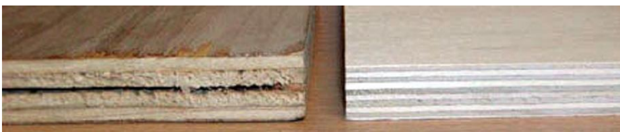
Сравнение фанеры плохого качества слева с фанерой отличного качества справа
