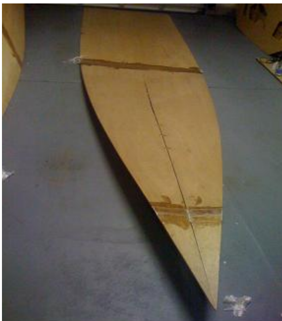
Нижняя (днищевая) панель, соединенная и сшитая
